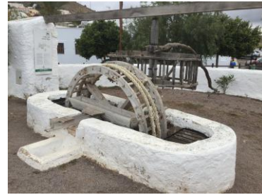
Schöpfrad zur Bewässerung von Feldern über einen Kanal. Cabo de Gata, Nijar, Spanien
