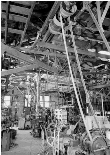
Massenproduktion durch Antriebsmaschine und Transmissionsriemen
